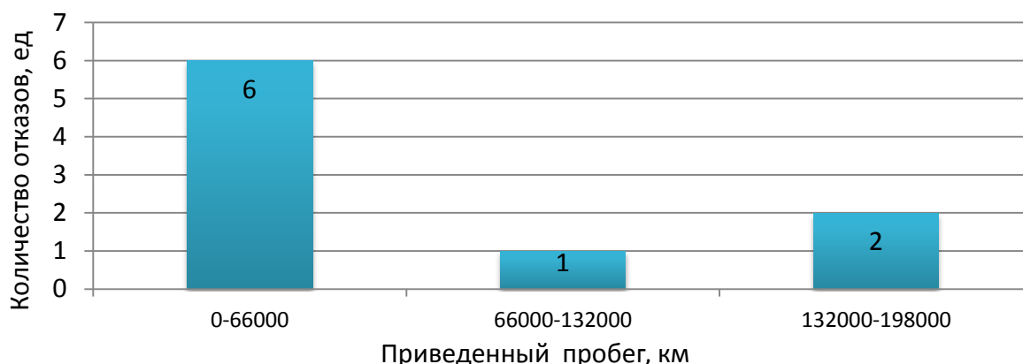
Рисунок 3. Количество отказов ПГУ по периодам приведенного пробега
