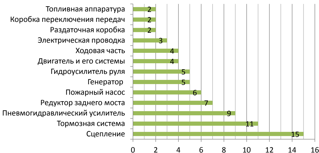
Рисунок 2. Число поломок узлов и агрегатов АЦ 3,0-40 (43206) 1МН
